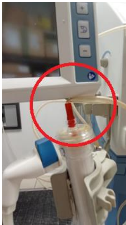
Figura 4. Línea de sangre curvada por el panel remoto
